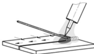
Рис. 8.6. Пример манипуляции присадочной проволокой при TIG сварке.
