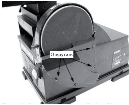
Рис. 14 Зняття кришки для заміни круга
